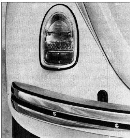
Rückleuchte mit größerer Lichtaustrittsfläche. Rückfahrscheinwerfer als Mehrausstattung
