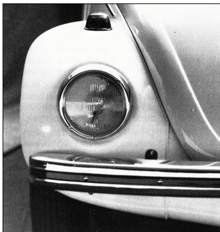
Geänderte vordere Kotflügel mit senkrecht stehenden Scheinwerfern. Die Ziergitter in den vorderen Kotflügeln sind entfallen (außer VW 1200)
