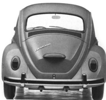
Die Motorhaube ist im unteren Bereich kürzer, die Fläche für das Kennzeichen steht steiler. Die Mittelsicke ist entfallen, die Kennzeichenleuchte wurde der neuen Form angepasst.
